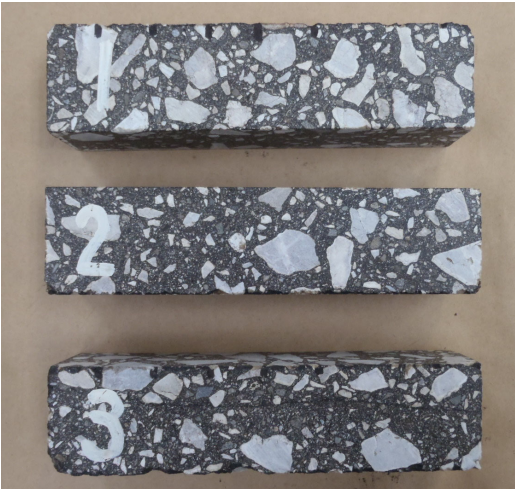
写真-3 供試体の切出し (4×4×16 cm)
