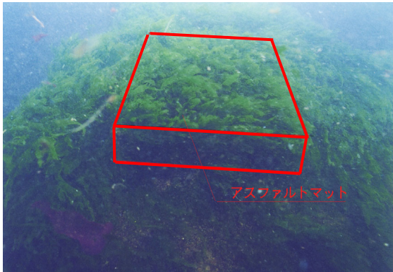
写真-4 アスファルトマット供試体に繁茂した海藻（暴露後 3 ヶ月）
